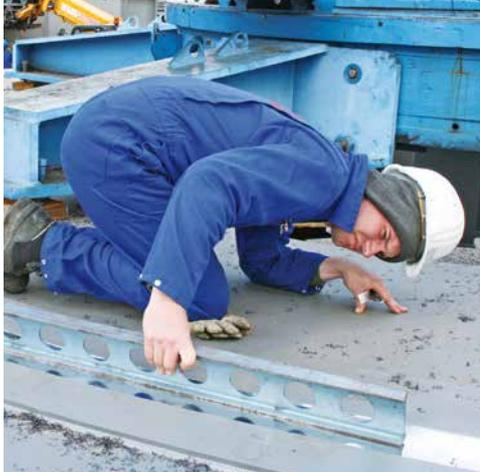
Die Vermessung der Flanschflächen geschieht bei der Durchführung von Rundfräsarbeiten mittels unserer Lasermesstechnik oder mittels Messuhren. Etwaige zu erstellende Neigungen werden mit elektronischen Maschinenwasserwaagen nachgewiesen.
