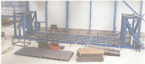
Die mobile Fräsanlage für Kesselgerüststützen ist die neueste Eigenkonstruktion der Becker GmbH.
