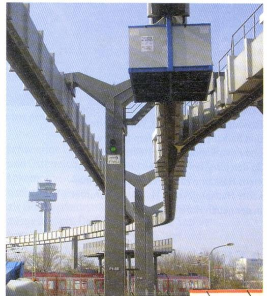
Mobile Fräsarbeiten für Siemens im Fahrweg des SkyTrain Düsseldorf: In das von der Firma Becker entwickelte Fahrzeug wurde die vorhandene Fräseinheit integriert. Foto: E. Becker GmbH
