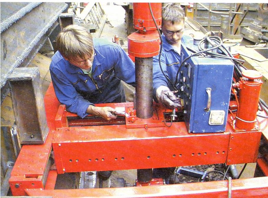
Instandsetzung: Fräsarbeiten an einer Schrottpresse. Foto: E. Becker GmbH
